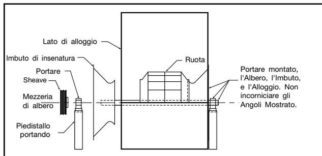
9. Installare il motore sulla base. Allineare accuratamente alberi per unità di installazione.
