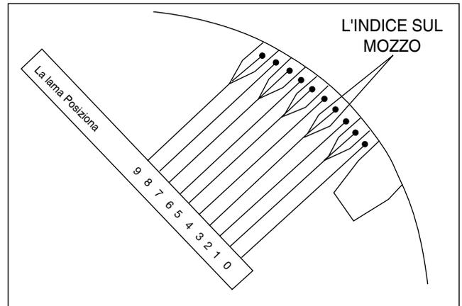
di Axiad, l'angolo di lama può essere aggiustato togliendo lo schermo di insenatura. Sui ventilatori di ducted, il caso è fornito con un 8-avanza la porta quadrata nel tubo di ventilatore. Per regolare il lancio di lama, procedere come il folbasso:
