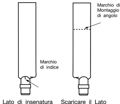
Stringere le noci di serratura al torque proprio per la Tavola 8. Ancora controllare il montaggio di angolo. Ruotare l'elica per controllare l'angolo su ogni lama nella stessa posizione.
